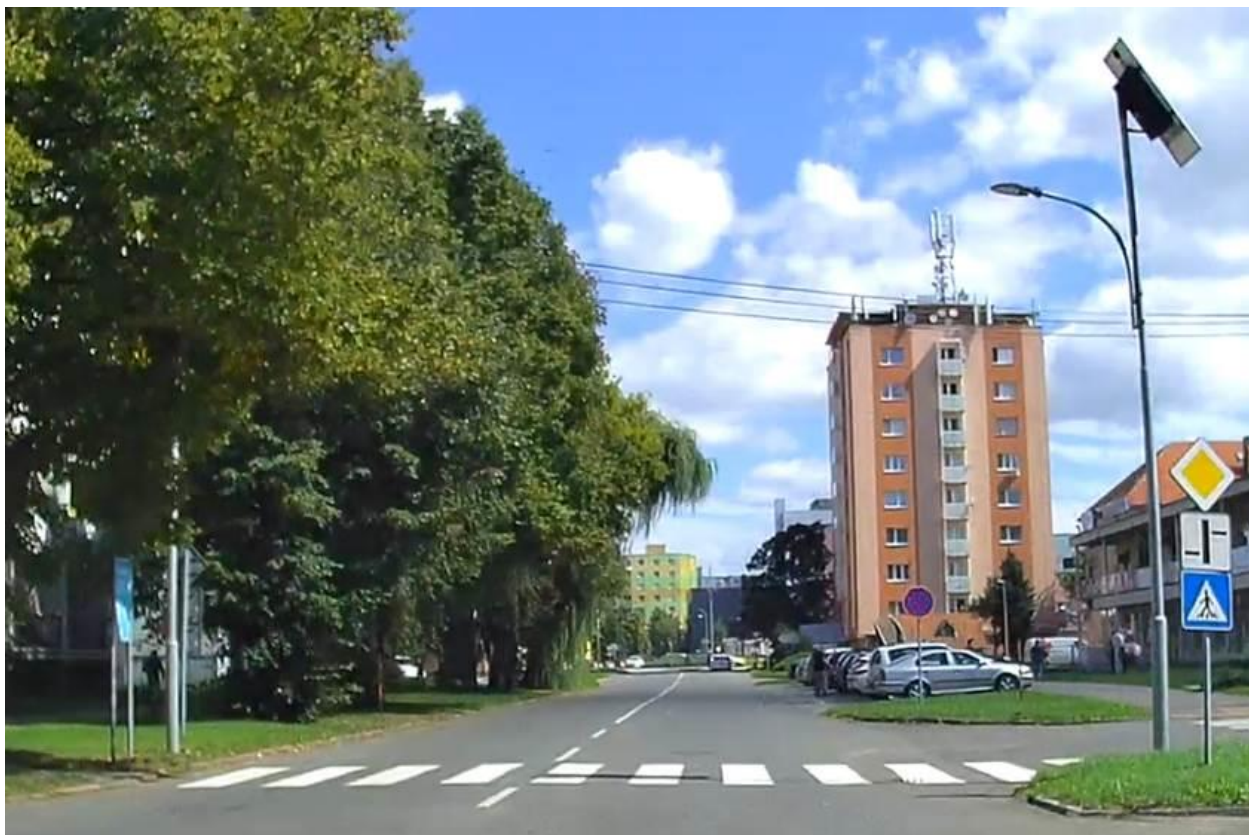
Obr. 17 Nevhodný spôsob osvetlenia prechodov pre chodcov
